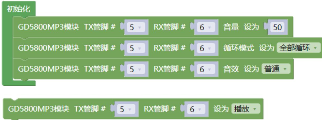
程式解析：MP3 模組的 TX 管腳接 Arduino 的 D5 引腳，RX 管腳接 Arduino 的 D6 引腳，並且音量設置為 50；設置音樂的迴圈模式為全部迴圈(迴圈模式分為：全部迴圈、資料夾內迴圈、單曲迴圈、隨機迴圈)，並且音效為普通(音效分為：普通、流行、搖滾、爵士、古典、低音)，然後播放檔。
